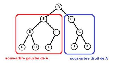
Les sous-arbres gauche et droit de A sont eux-mêmes des arbres dont les racines sont respectivement B et C. Ces noeuds possèdent eux-même des sous-arbres gauche et droit. Par exemple, le noeud C possède un sous-arbre gauche, qui est vide, et un sous-arbre droit qui est l'arbre dont la racine est G. Ainsi de suite...
